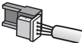
3. Use um alicate tipo universal para travar as duas partes do conector.
