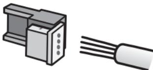
2. Coloque a parte onde foram inseridos os fios contra a base do conector até encaixá-los, travando as duas partes. Verifique se os fios estão bem firmes;
